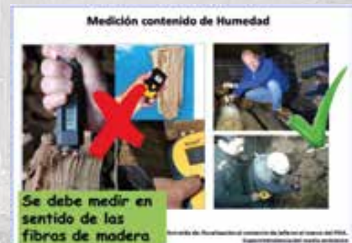
Figura 17- Consideraciones para medir humedad.
